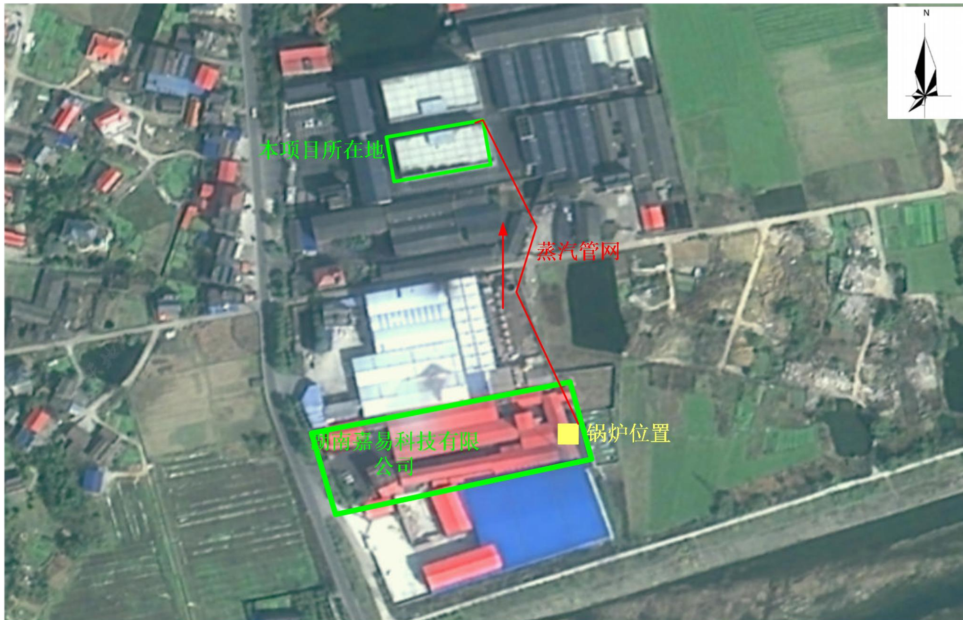
附图 10 企业蒸汽管网走向图
