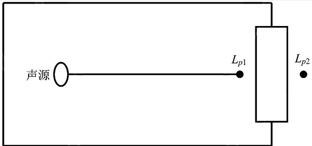
图 4-1 室内声源等效为室外声源图例
